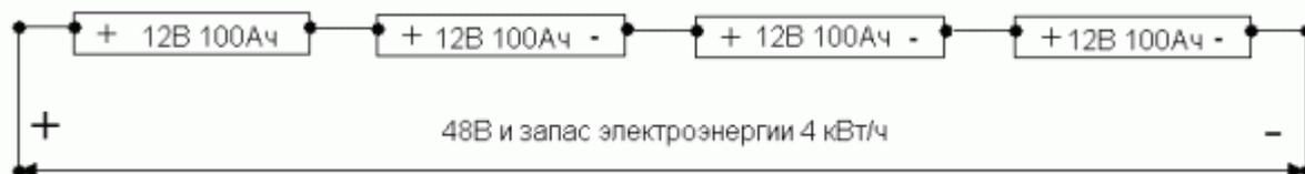
Схема подключения одного комплекта аккумуляторных батарей к ветрогенератору .
